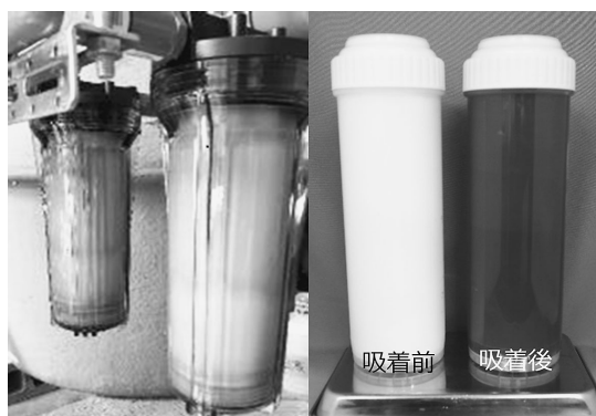
設置した吸着剤を通過させたメッキ液の比較写真 （左）吸着前のカートリッジと（右）吸着後のカートリッジ
